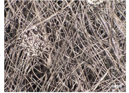
(写真1) 不織紙に銅合金を真空蒸着した拡大写真
