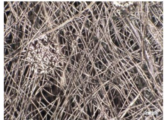
図：不織布に銅合金蒸着拡大写真
