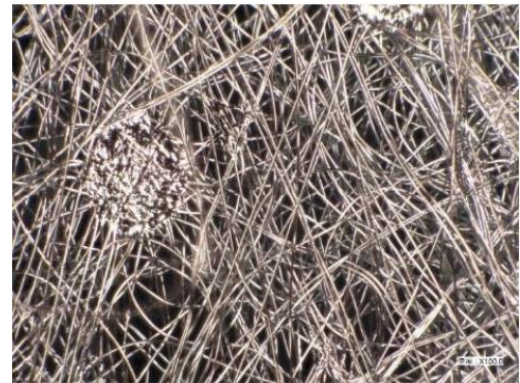
図：不織布に銅合金蒸着拡大写真
