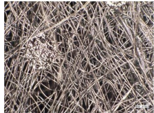
図：不織布に銅合金蒸着拡大写真
